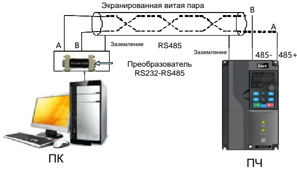
Рис. 9–1 Подключение RS485 на одном ПЧ
